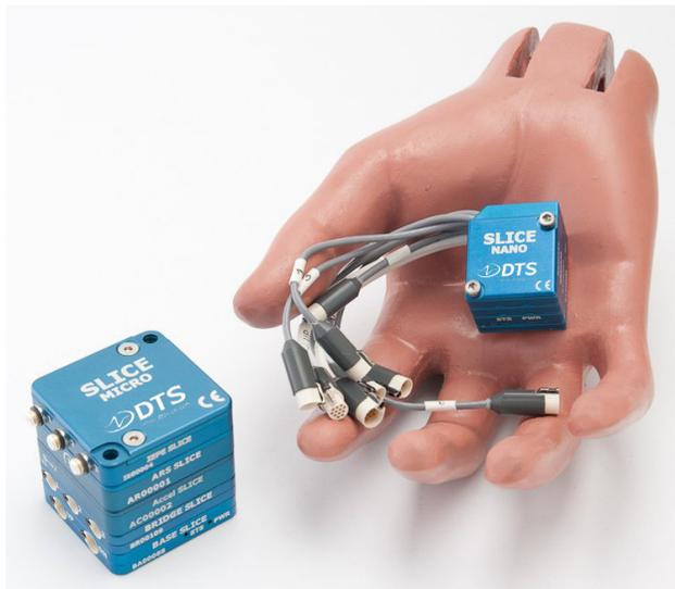
Les SLICE MICRO et SLICE NANO sont configurables par l'utilisateur avec des modules d'entrée 3 voies qui s'empilent pour créer un système d'acquisition spécifique.
